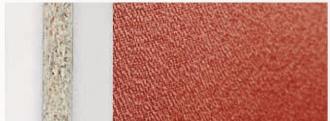
Les cloisons acoustiques HÉLICE sont composées d'un panneau de particules de forte densité (épaisseur 10 mm), sur lequel est collée de part et d'autre une mousse de Mélangine (épaisseur 8 mm). Les performances acoustiques de nos cloisons ont été **testées en laboratoire par le F.C.B.A.** Les rapports de tests sont disponibles sur demande. L'ensemble est recouvert d'un tissu 100 % polyester. Inflammabilité : classe 1 (BS 476-7 et EN ISO 1021 1-2).
